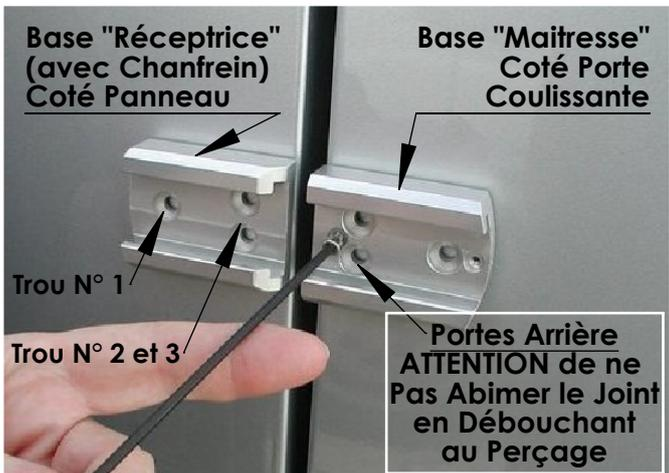
5 - Percez & Posez en 1er le Rivet du Milieu (1) puis Vérifier l'Alignement avec le Coulisseau (faire légèrement Pivoter si nécessaire) et Percez & Posez les 2 autres Rivets (2 & 3) après avoir remis le Gabarit de Perçage.
