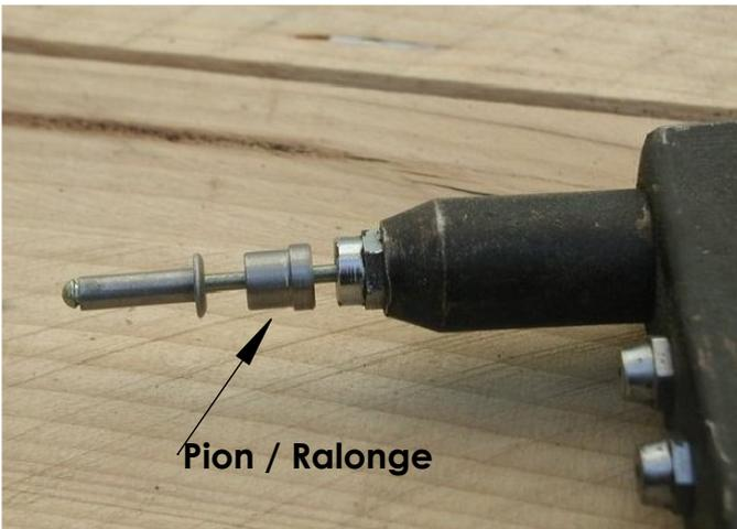
3 - Contre-Percer le Trou N° 2 et poser le Rivet avec la Ralonge puis idem pour le Trou N° 3
