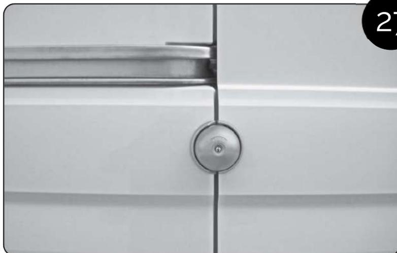
**IT** Posizionare la calotta di UFO (fornita separatamente) e verificare che la serratura si chiuda correttamente. Il montaggio sul portellone laterale è ultimato
