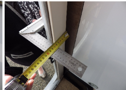
3 - Mesure de la Cote Mini - Ici 62
