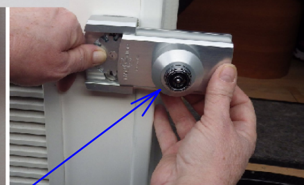
16 - Pignon en Appuis Enfilez le Coulisseau qui va trouver Automatiquement sa Place
